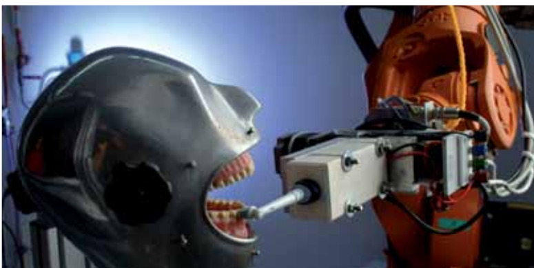
Der Zahnputzroboter von Oral-B simuliert die Anwendung von Hand- oder Elektrozahnbürsten und ermöglicht objektive Produktprüfungen unter standardisierten und kontrollierten Bedingungen.
